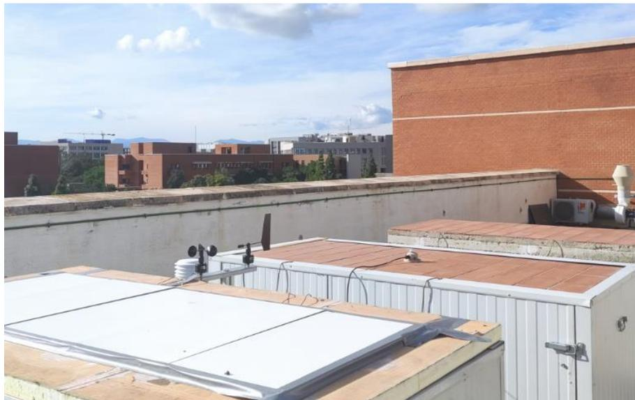
Figura 18. Pieza extruida alveolar reflectiva junto con prototipo de referencia baldosín catalán.
