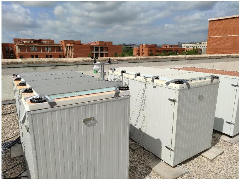
*Figura 23. Sistema 1.8 C pieza aligerada colocada como STE con cámara cerrada*
